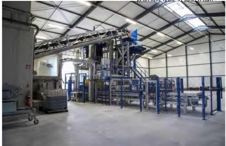
תמונה 20: מבט מהצד על מכבש הבטון מצד ההגעה של בטון המפ
